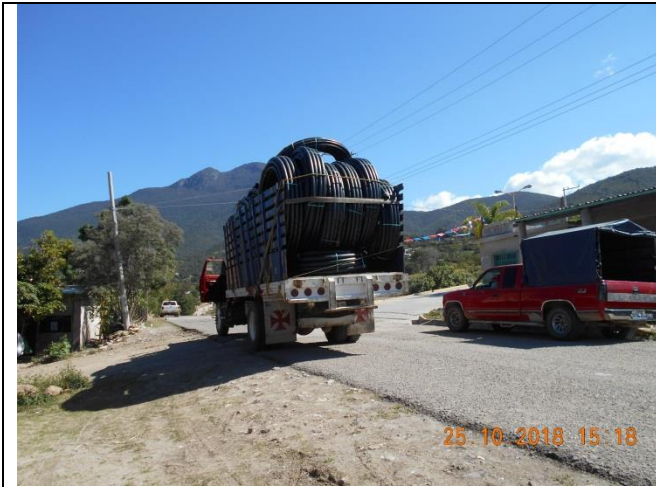
Suministro de tubería de 2 1/2" RD 13.5
