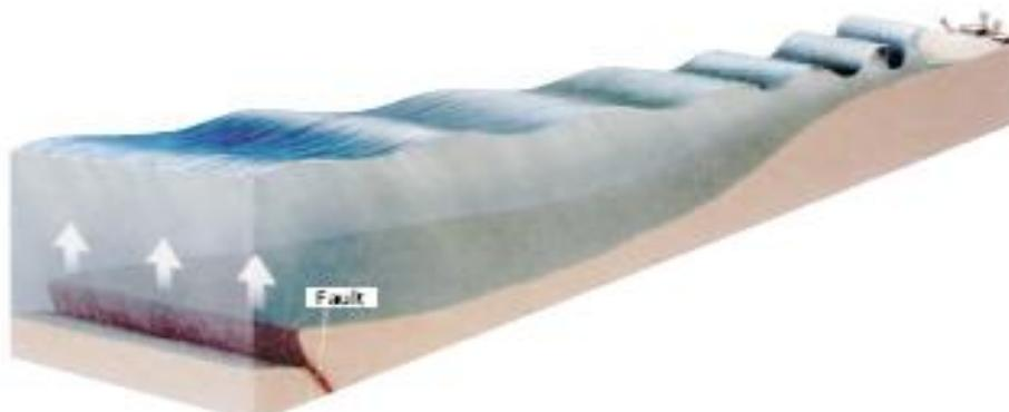
**Figura 2.18.** Tsunami generado por el movimiento vertical de una falla en el fondo del océano.
