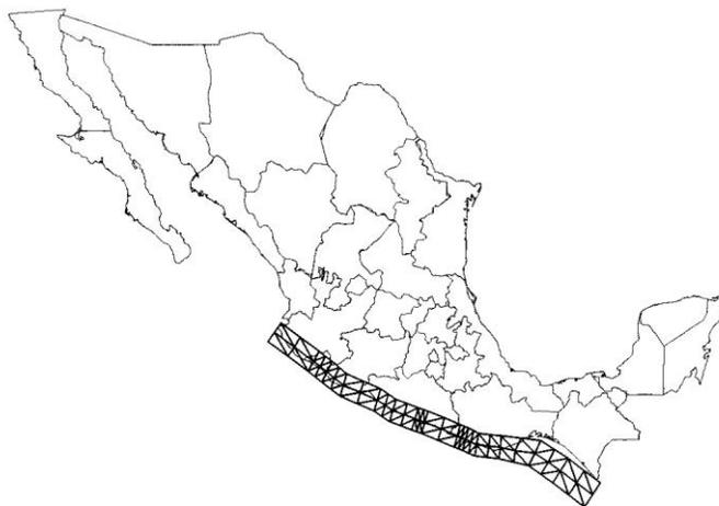
**Figura 3.6.** Subdivisión de las zonas generadoras de sismos de subducción.
