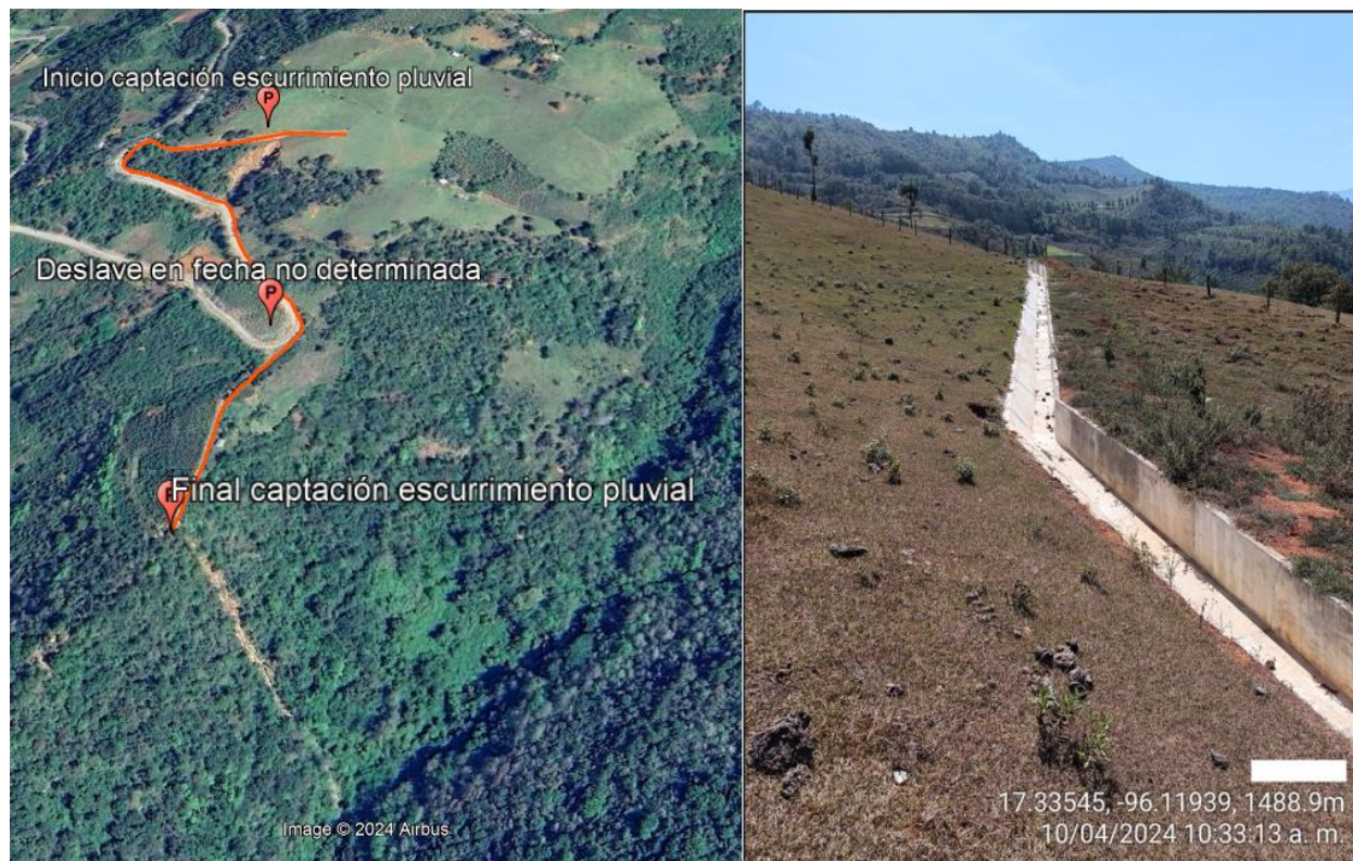
Imagen 18. Ubicación, trazo y vista actual del drenaje pluvial al sudoeste de Santo Domingo Roayaga
