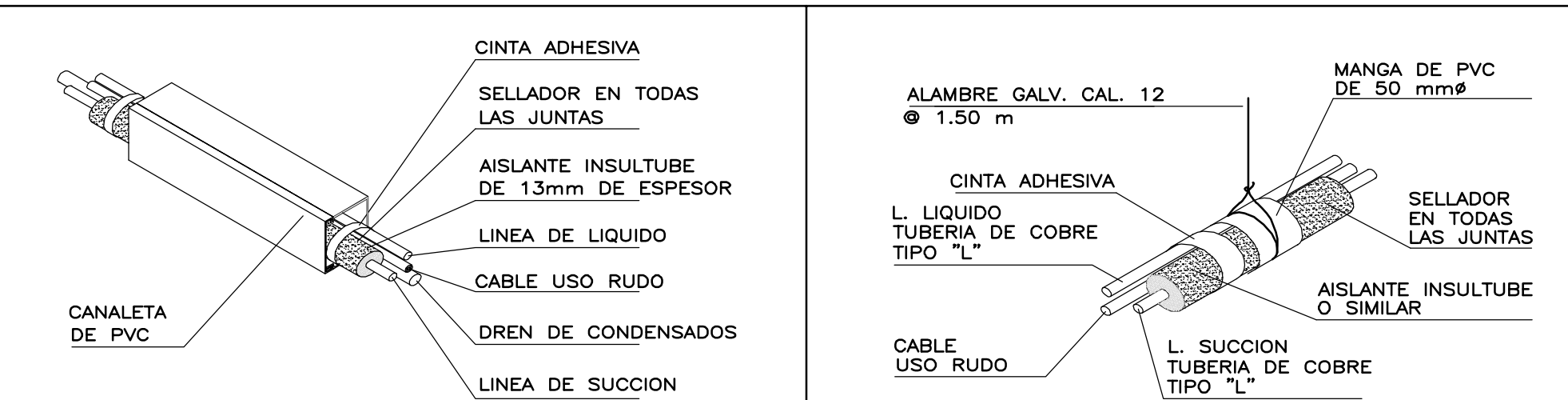
1 CANALETA PARA TUBERIAS DE REFRIGERANTE 2 SOPORTE DE TUBERIAS DE REFRIGERANTE
