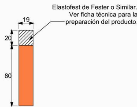
DETALLE 5. ELEVACIÓN JUNTA CONSTRUCTIVA ENTRE PISO Y COLUMNA ESCALA: S/E
