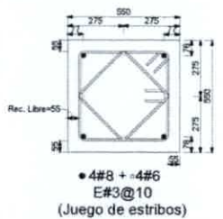
CORTE 1-1 PLANTA ARMADO DE DADO D1 ESCALA: S/E COT: mm
