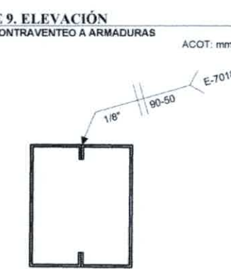
DETALLE 9. ELEVACIÓN CONEXIÓN CONTRAVANTEO A ARMADURAS ESCALA: S/E ACOT: mm
