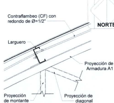
DETALLE 6. ELEVACIÓN CONTRAFLEBOS ESCALA: S/E
