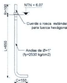
DETALLE 3. ANCLAJES ELEVACIÓN ESCALA: S/E acot: mm
