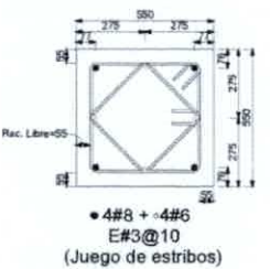
CORTE 1-1 PLANTA ARMADO DE DADO D1 ESCALA: S/E
