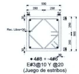
CORTE 2-2 PLANTA ARMADO DE COLUMNA C1 ESCALA: S/E
