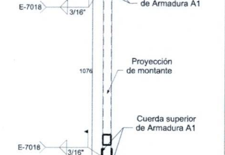
DETALLE 10. CORTE X-X CRITERIO GENERAL PARA FORMAR ARMADURAS A1 ESCALA: S/E ACOT: mm
