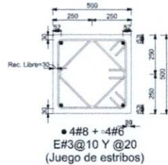
CORTE 2-2 PLANTA ARMADO DE COLUMNA C1 ESCALA: S/E ACOT: mm
