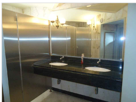
IMAGEN 10: LAVABO DE GRANITO NEGRO, CON PLACAS DE 5CM DE ESPESOR, ACABADO PULIDO.
