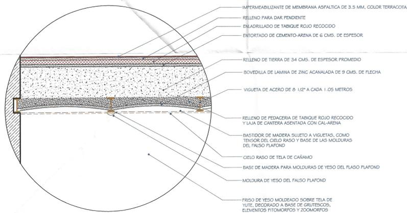
CORTE ESQUEMATICO DE LA CUBIERTA
