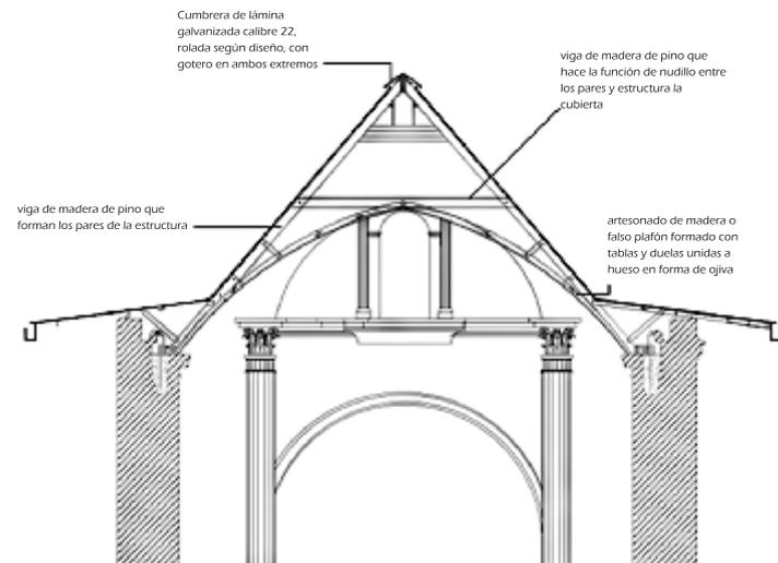
Conformación de la estructura de la cubierta de madera y arcesonado del intradós.
