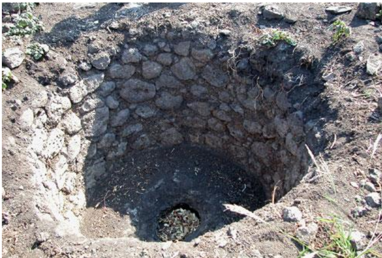
Horno revestido de piedras para la cocción de mezcal.
