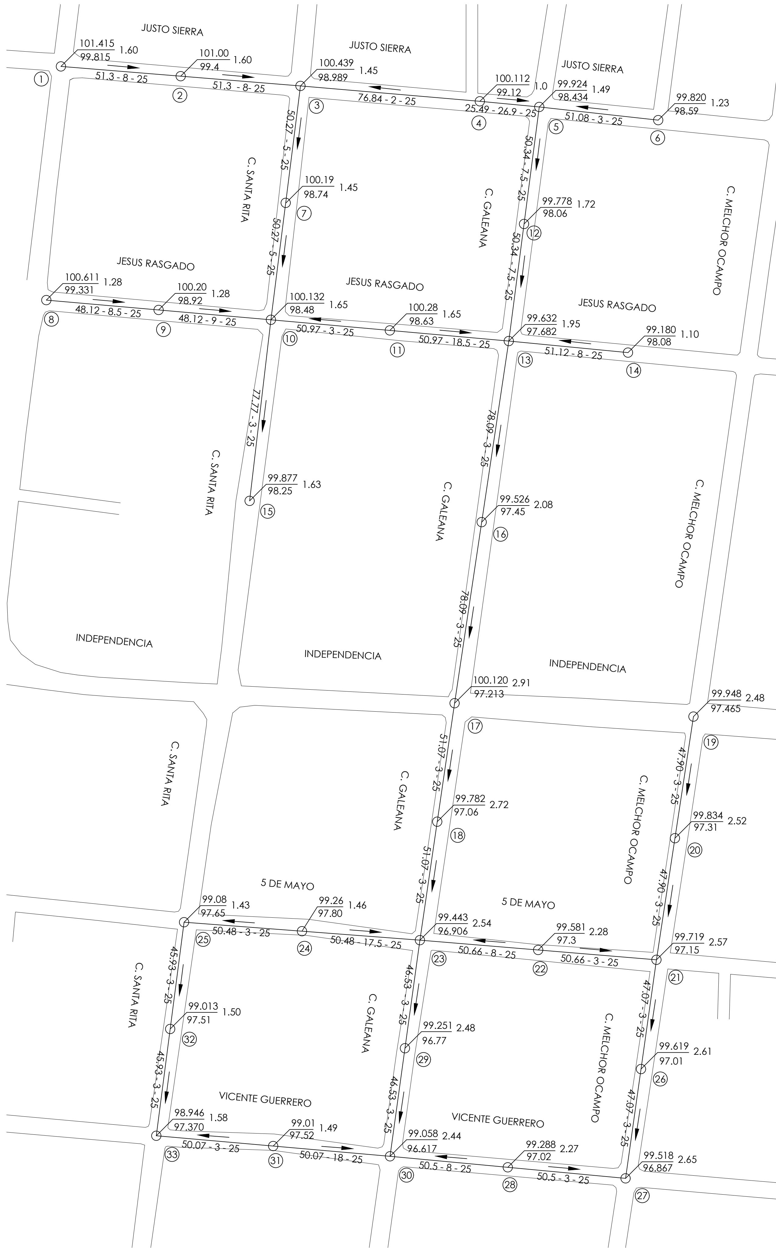
PLANTA RED DE ALCANTARILLADO TRAMO 01 ESCALA: 1:1000
