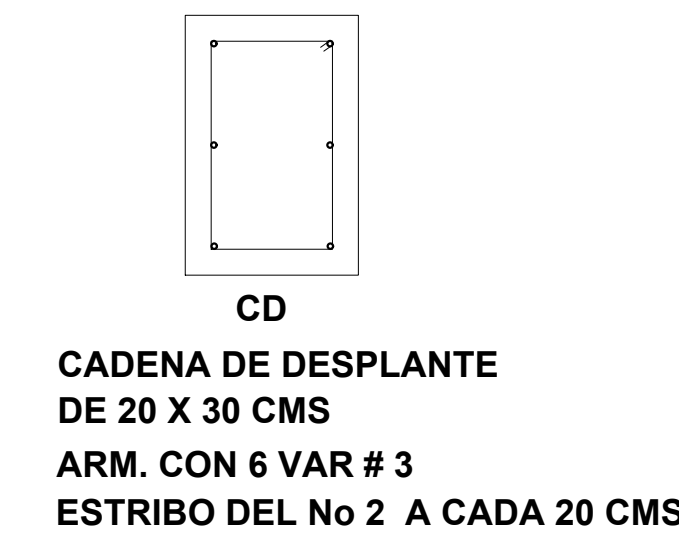
CADENA DE DESPLANTE DE 20 X 30 CMS ARM. CON 6 VAR # 3 ESTRIBO DEL No 2 A CADA 20 CMS
