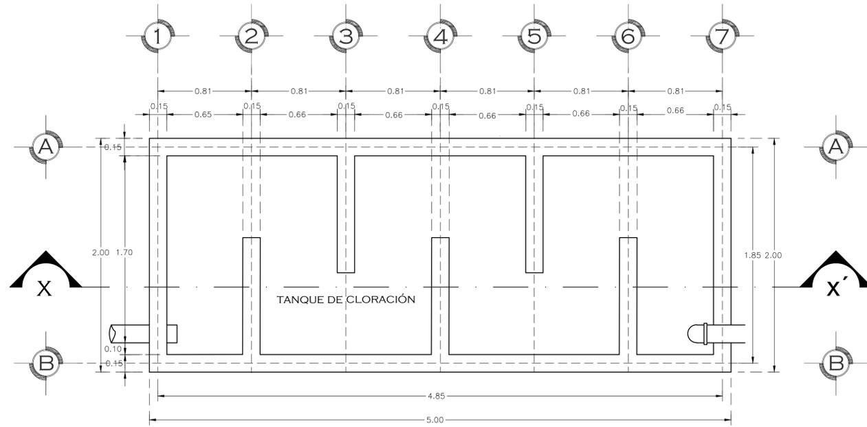
**PLANTA TANQUE DE CLORACIÓN**
