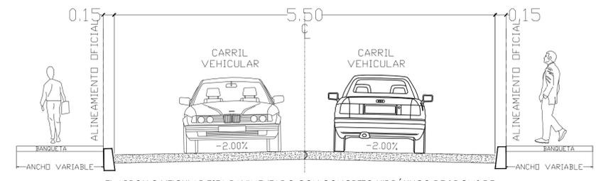
EL ARROLLO VEICULAR ESTÁ PAVIMENTADO CON CONCRETO HIDRÁULICO DE 15 CMS DE ESPESOR CON CONCRETO DE F'c= 250 KG/CM2. ACABADO RAYADO CON CEPILLO METÁLICO.
