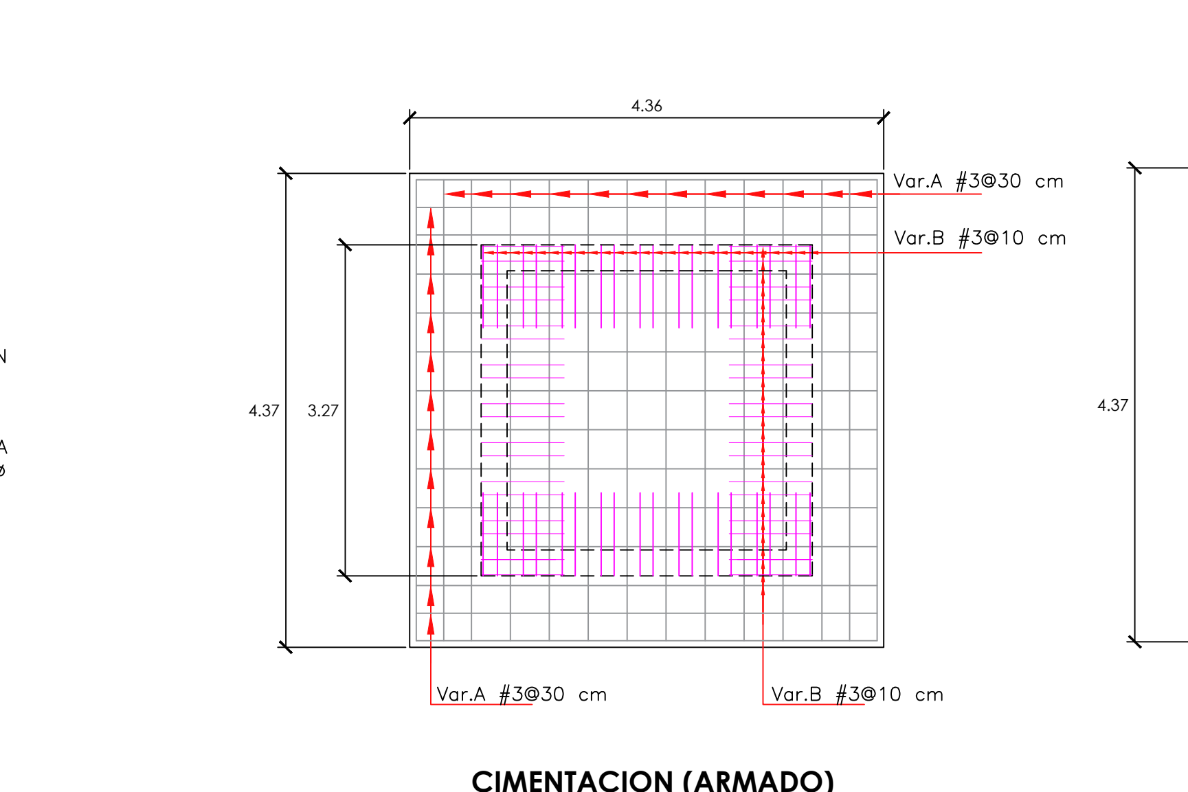
CIMENTACION (ARMADO) PARILLA INFERIOR ESC. 1:40
