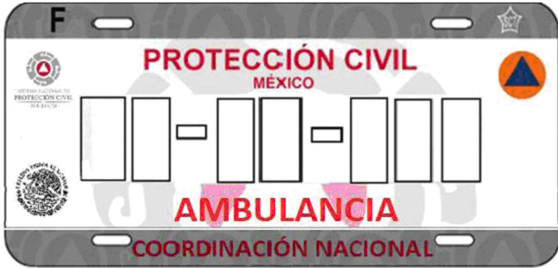
Figura 35 Vehículos de Protección Civil Ciudad de México, entidades federativas y Gobierno Federal Separación de caracteres (letras y dígitos), placas con siete caracteres. Acotaciones en milímetros. El ancho de los caracteres debe ser de acuerdo a lo indicado en la figura. Las dimensiones de los guiones serán de 16 x 5.6. Se incorporará la letra "T" y "F" según corresponda a la placa.
